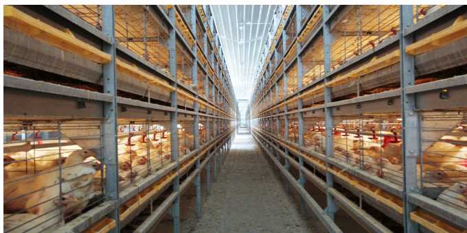
BroMaxxコロニーケージシステム (多段ブロイラーケージ設備例)
